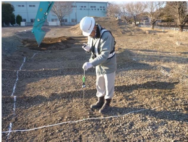
(3) 差の確認（鉛直方向の測定精度）
