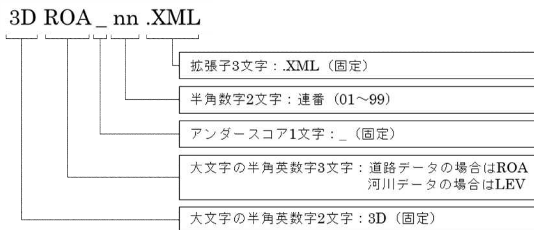
図 21 データ交換標準（案）に則った 3 次元設計データ（XML ファイル）の命名規則
