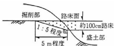
(c) 現地盤がすり付け区間を長く取ることが不経済となる場合
