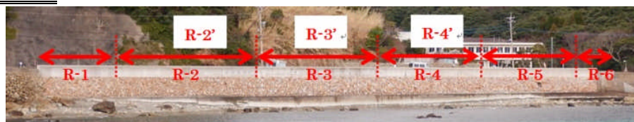
写真-3 飛沫発生個所の設定（R-2'、R-3'、R-4'については、背後に雨量計を設置。）
