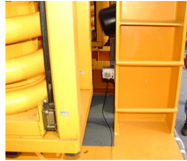
図 5-2 制振装置重錘変位計設置状況
